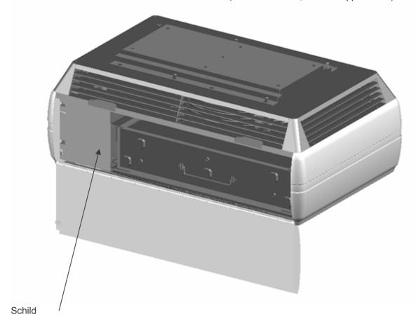
Das Typenschild gibt die technischen Funktionsdaten und das Identifikationszeichen der Maschine wieder.
