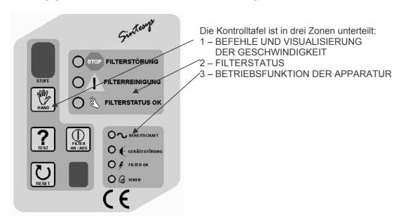
Die Einrichtungen, die den manuellen Eingriff und eine ersichtliche Kontrolle der Funktionsbedingungen ermöglichen, sind nachfolgend wiedergegeben.
