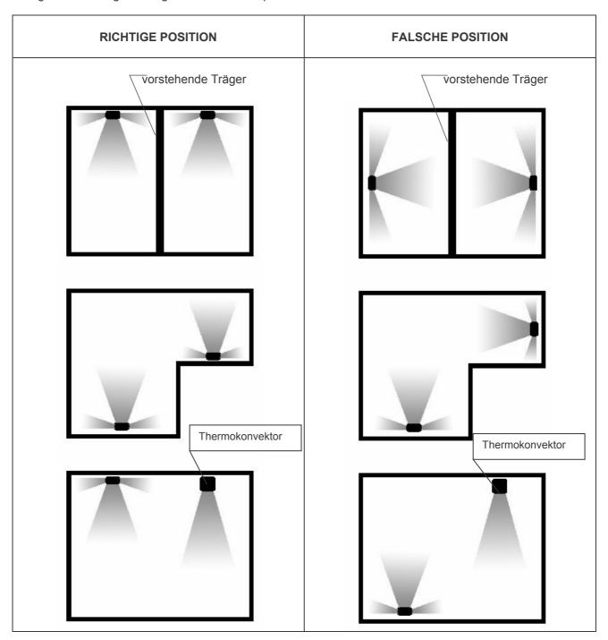
Die Wandgeräte müssen auf einer Höhe von einschliesslich 2,8 bis 3,1 Meter vom Boden entfernt installiert werden. Wenn während der Installationsphase alle Anweisungen beachtet werden, erzielt man die höchste Leistung. Das Gerät erfüllt seine Arbeit, indem er die Luft hautnah an die Decke drückt, sie entlang der vorderen Wand und der seitlichen Wände herunter gleiten lässt und wieder zu sich zurückruft, und somit den Luftzyklus mit dem Effekt, genannt "Halbcoanda", wieder schliesst.
