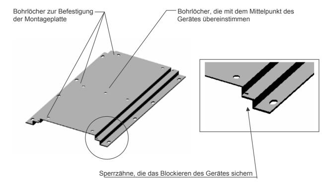
Die Omega Montageplatte hat, ausser den sechs äusseren Bohrlöchern zur Befestigung, ein oder zwei weitere Bohrlöcher, von denen eines in der Mitte genau mit dem Gerät übereinstimmt. Auf diese Art wird die Installation erleichtert.
