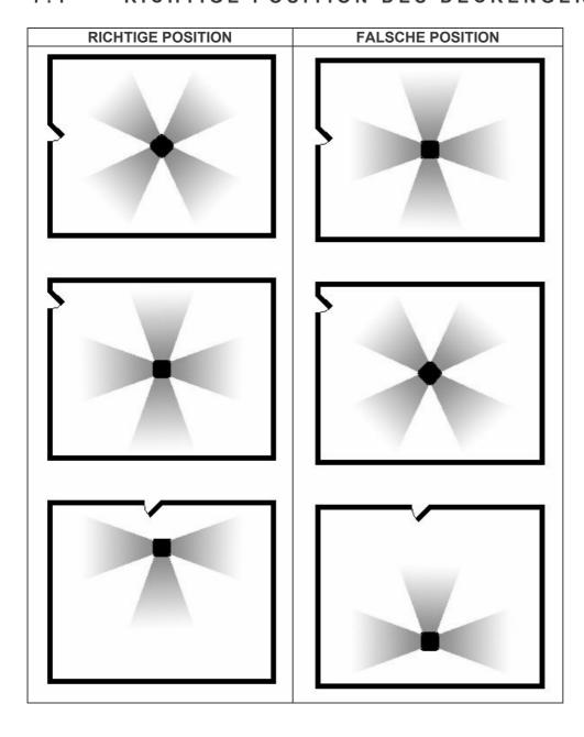
Die Deckengeräte müssen auf einer Höhe zwischen 2.8 und 3.5 Metern vom Boden entfernt. installiert werden. Wenn während der Installationsphase alle nachfolgenden Anweisungen beachtet werden, erzielt man die höchste Leistung. Das Gerät erfüllt seine Arbeit, indem er die Luft hautnah an die Decke drückt. sie den Wänden entlang herab gleiten lässt und sie in die Mitte des Raumes zurückruft. Das ganze Lokale wird mit dem Luftzyklus einbezogen dank dem Effekt genannt "Coanda".
