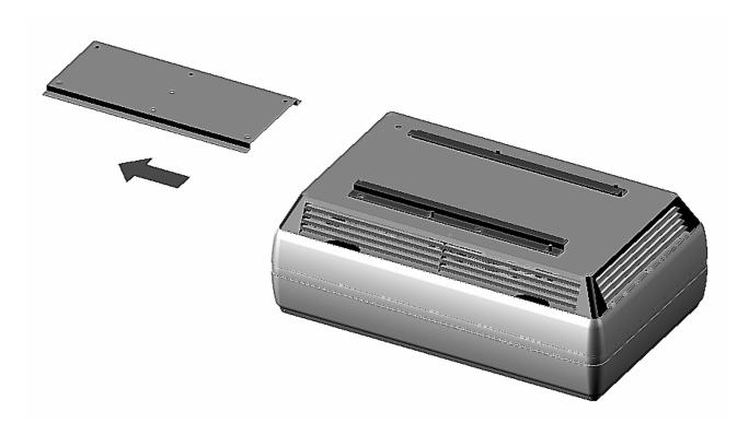
Die Verankerung des Gerätes erfolgt mit der Omega Montageplatte, die zwischen den zwei fixierten Führungsschienen zentriert wird, indem das Gerät bis zu den heraus gearbeiteten Sperrzähnen der zwei fixierten Führungsschienen in die Sicherheitsstellung einschnappt. Auf diese Art wird das Abhaken des Gerätes verhindert, es sei denn, dass dieses nicht hochgehoben wird.
