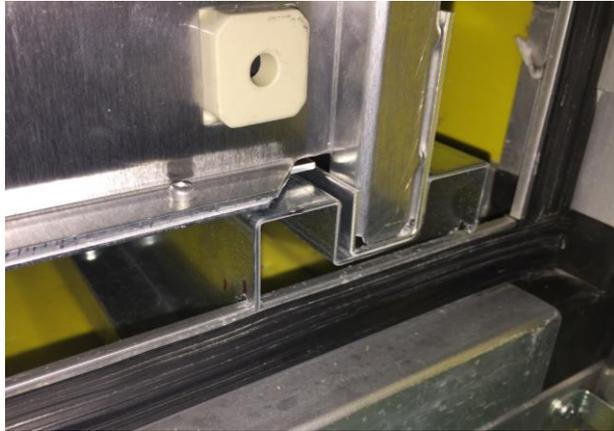
Umbau mit einfacher Einschubschiene
