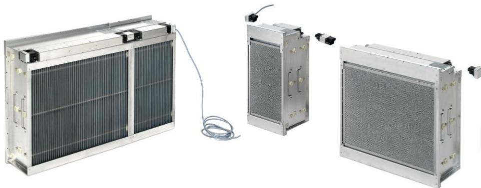
Die aktuelle Messreihe unserer Elektrofilter Typ FE zeigt eindeutig, dass auch im Nanobereich ein sehr hoher Abscheidegrad besteht. Bei 0.02  $\mu\text{m}$  resultieren noch ca. 60% Abscheidung und ab 0.03  $\mu\text{m}$  erhalten wir Werte über 90%.
